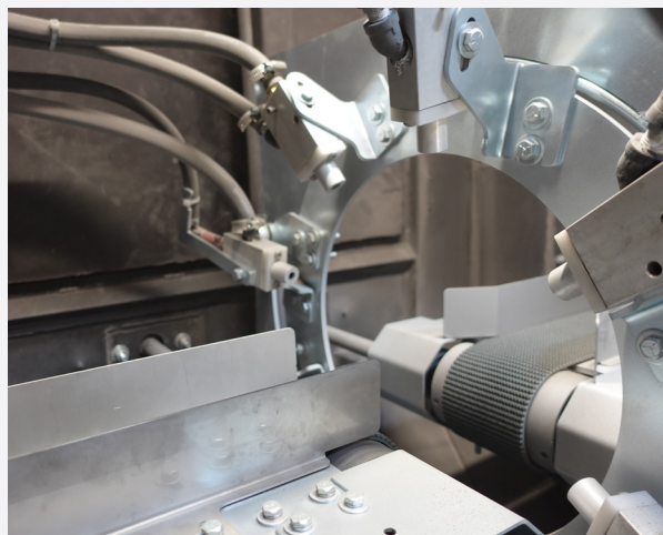
Buses oscillantes sur anneau circulaire pour une couverture à 360°
