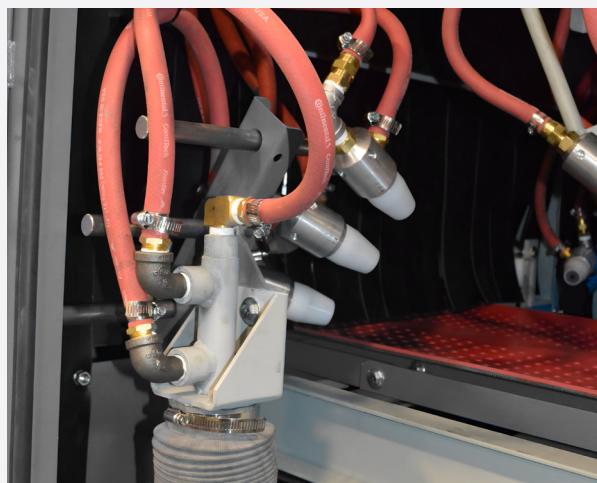
Buses fixes ou oscillantes pour couvrir les deux côtés des pièces mobiles
